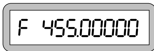
Рис. 11. Индикация значения частоты 455 кГц.
