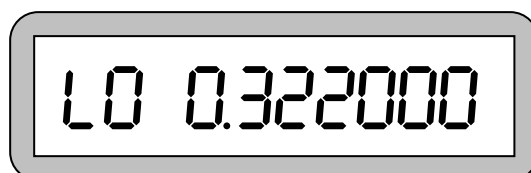
Рис. 15. Индикация длительности импульса 322 мкс.
