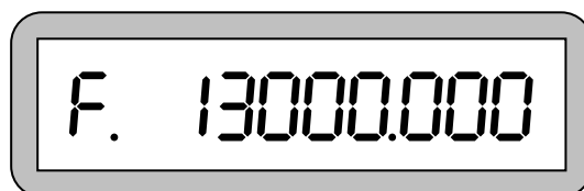
Рис. 12. Индикация значения 13 МГц с учетом промежуточной частоты.
