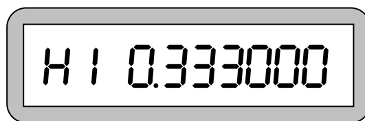
Рис. 14. Индикация длительности импульса 333 мкс.
